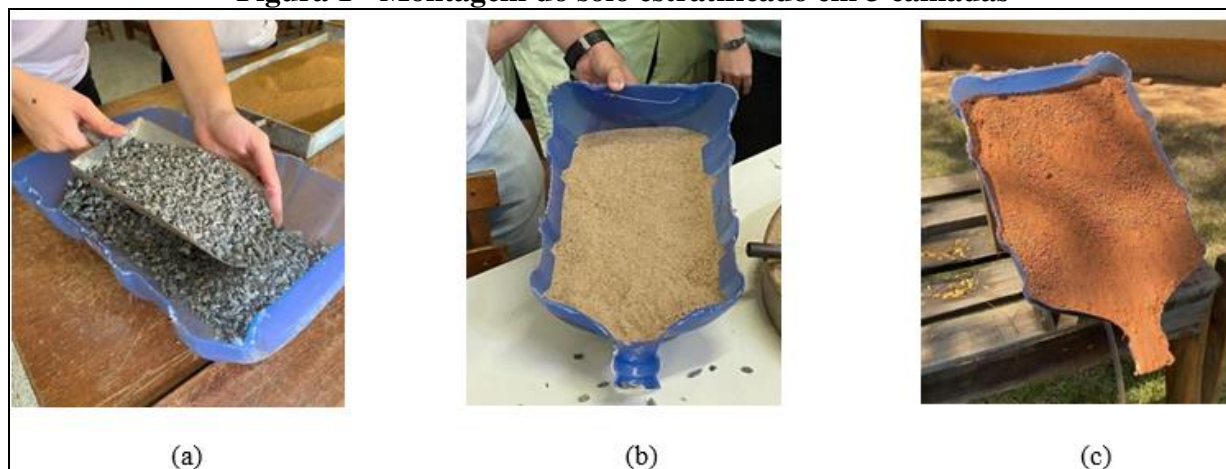
Figura 1 - Montagem do solo estratificado em 3 camadas
