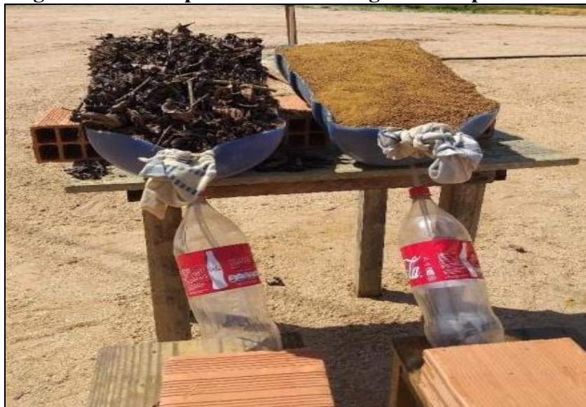
Figura 3 – Protótipos de bacias hidrográficas experimentais
